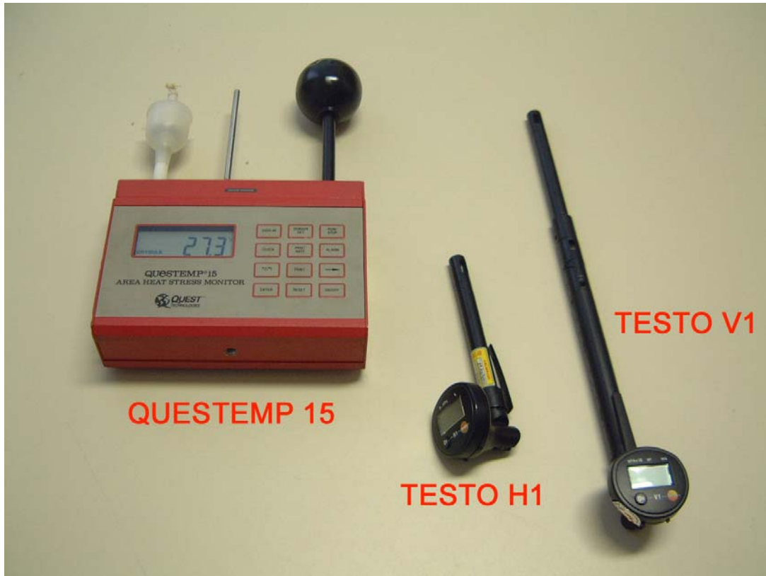
Figura 2 - Equipamentos de medição das variáveis ambientais
