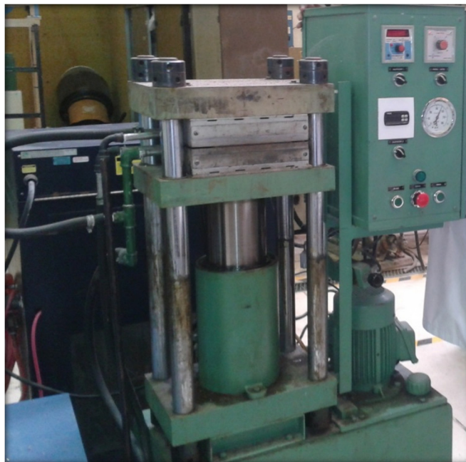
Figura 10. Prensa hidráulica utilizada na confecção dos filmes de TPS.
