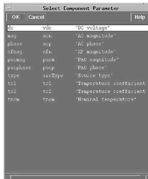
FIGURA A4. 19 - Selecionando o parâmetro variável da fonte para a análise DC do circuito
