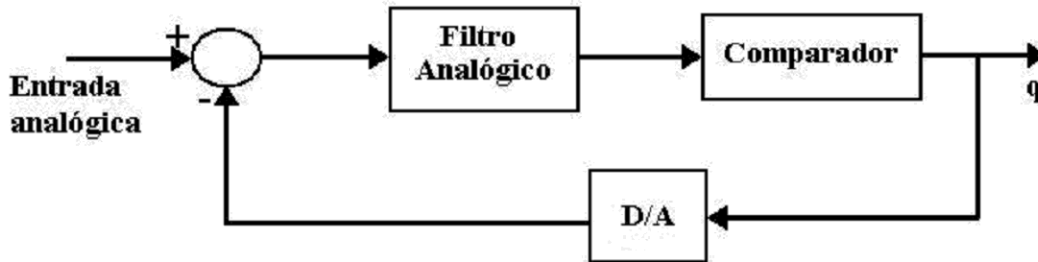
FIGURA 5.4 - Diagrama de blocos básico de um modulador \Sigma\Delta
