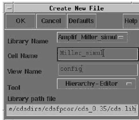
FIGURA A4. 35 - Criando um arquivo config para a simulação de um circuito em versões diferentes
