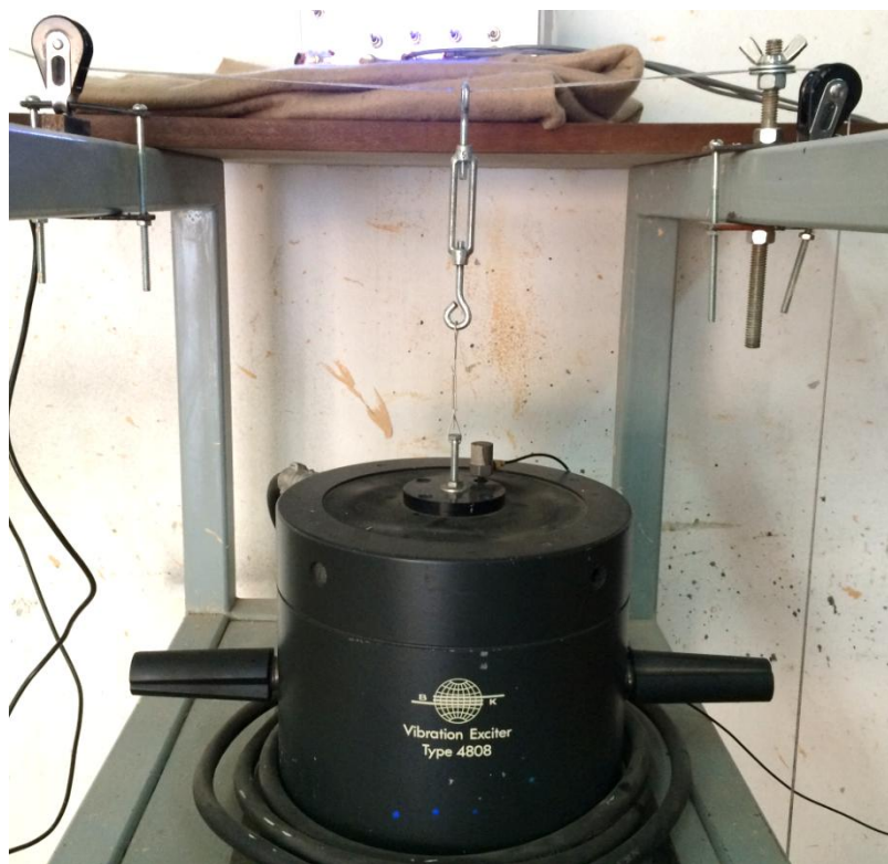
Figura 36 – Sistema para sobreposição de carga dinâmica à linha de ancoragem
