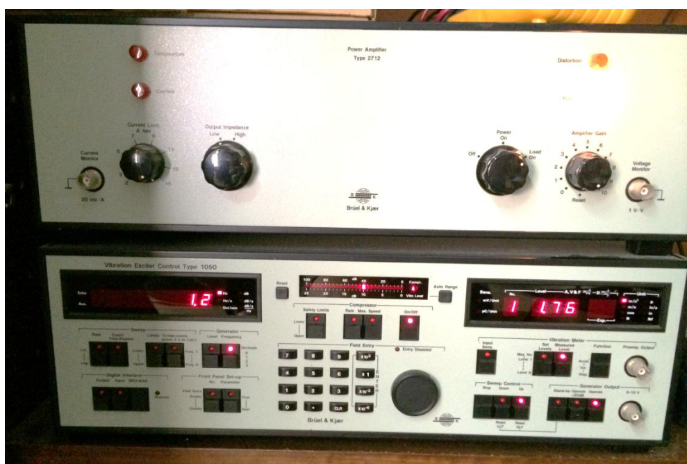
Figura 38 – Amplificador de potência tipo 2712 (acima) e controle de excitação de vibração tipo 1050 (abaixo)
