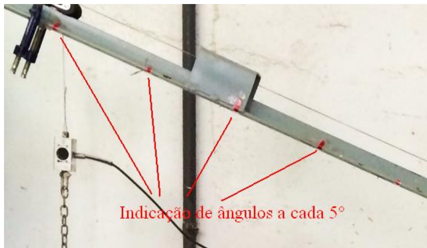
Figura 32 – Indicação dos ângulos no trilho metálico
