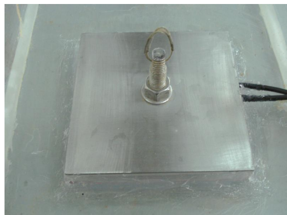
Figura 29 – Vista superior da célula de carga do fundo do tanque
