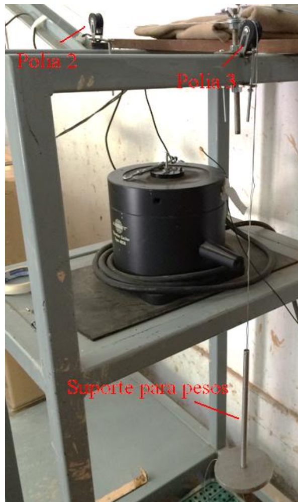
Figura 33 – Sistema de polias e suporte para pesos
