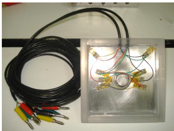
Figura 28 – Vista inferior da célula de carga do fundo do tanque
