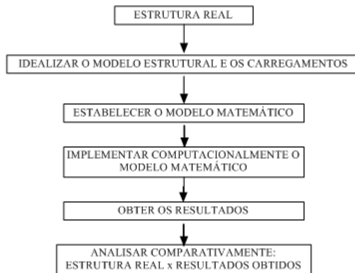
Figura 6 – Diagrama representativo do processo de idealização estrutural
