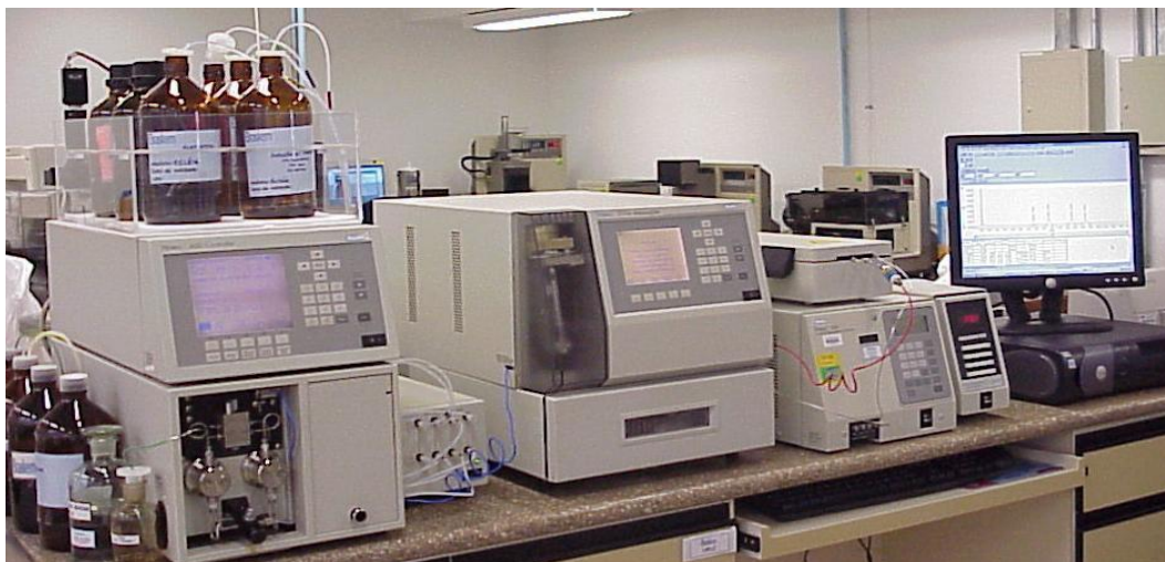
Figura 14 – Cromatógrafo Líquido de Alta Eficiência- marca Waters. Possui bomba quaternária, modelo 600, injetor automático, modelo 717plus e detector de ultravioleta, modelo 486.
