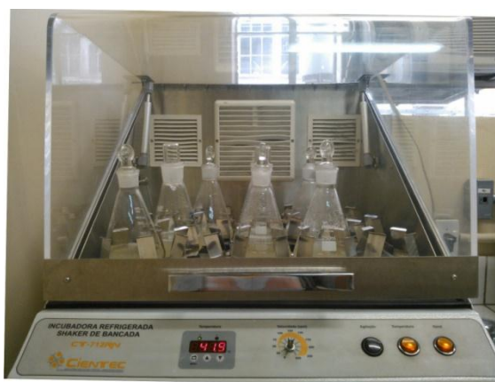
Figura 6. Incubadora refrigerada com agitação orbital utilizada durante a modificação da zeólita com quitosana e com HDTMA-Br.
