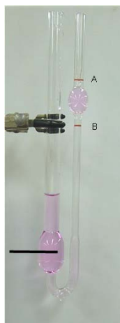
Figura 6 - Viscosímetro de Ostwald.
