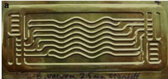
Figura 34 Peça utilizada em células de combustível conformada por processo EMF (GOLOWIN et al., 2007).
