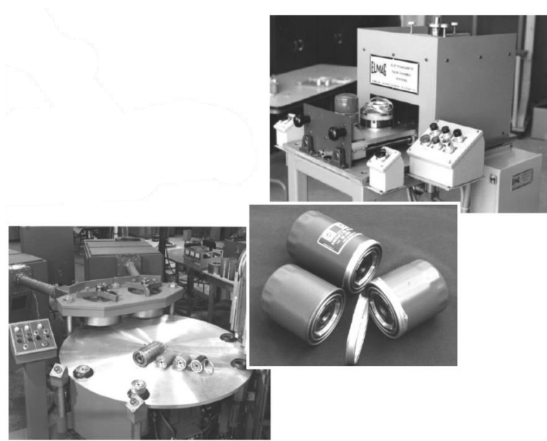
Figura 35 Estação de trabalho industrial de um processo EMF para montagem de filtros de óleo (ZITTEL, 2010).
