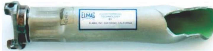
Tubo de torque do Boing 777 depois de um teste destrutivo. Este mostra que a junção realizada por impacto através do processo EMF, é mais resistente que o tubo de alumínio de alta resistência da série 2000.
