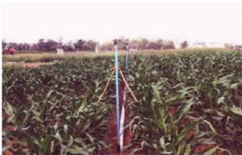
**Figura 5 - Sistema de aspersão portátil com laterais móveis.**
