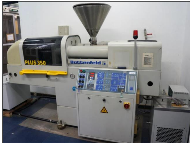
Figura 15: Injetora do LPA modelo PLUS 350, da marca Battenfeld
