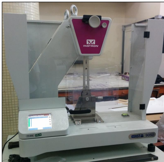
Figura 21: Máquina de ensaio de impactos, modelo CEAST 9050, da marca Instron.
