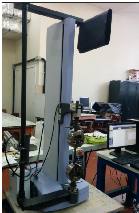
Figura 20: Máquina de Ensaio Universal Modelo EZ-LX da Marca Shimadzu
