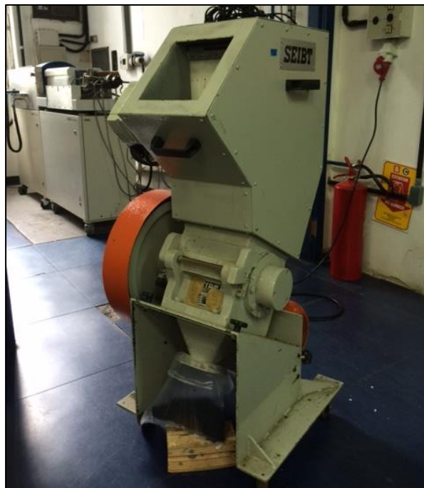
Figura 9: Moinho SEIBT de facas rotativo do LPA/IQ, modelo MGAS27180
