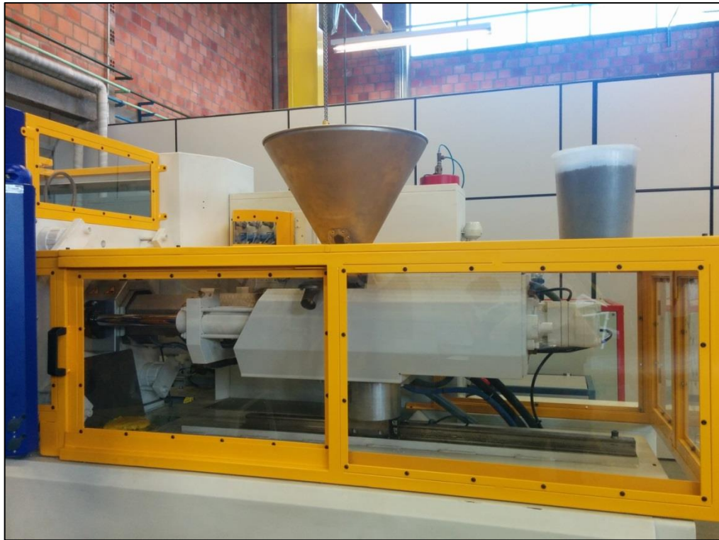
Figura 17: Injetora do CETEPO, visão da lateral da rosca recíproca, modelo TM 110/210 da marca Battenfeld.
