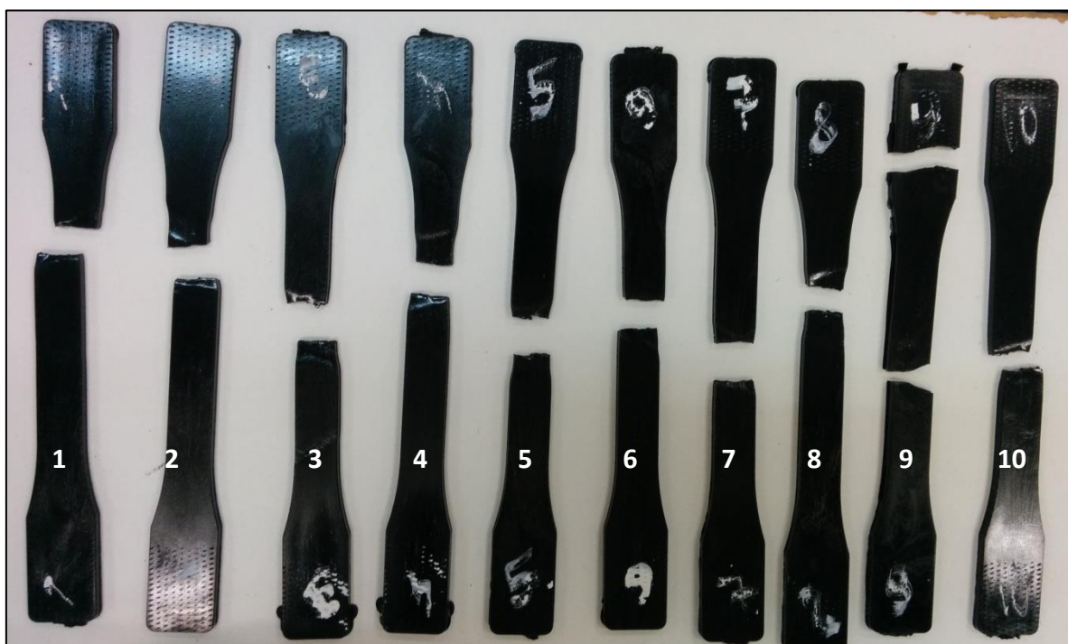
Figura 25: Corpos de prova após Ensaio de Tração
