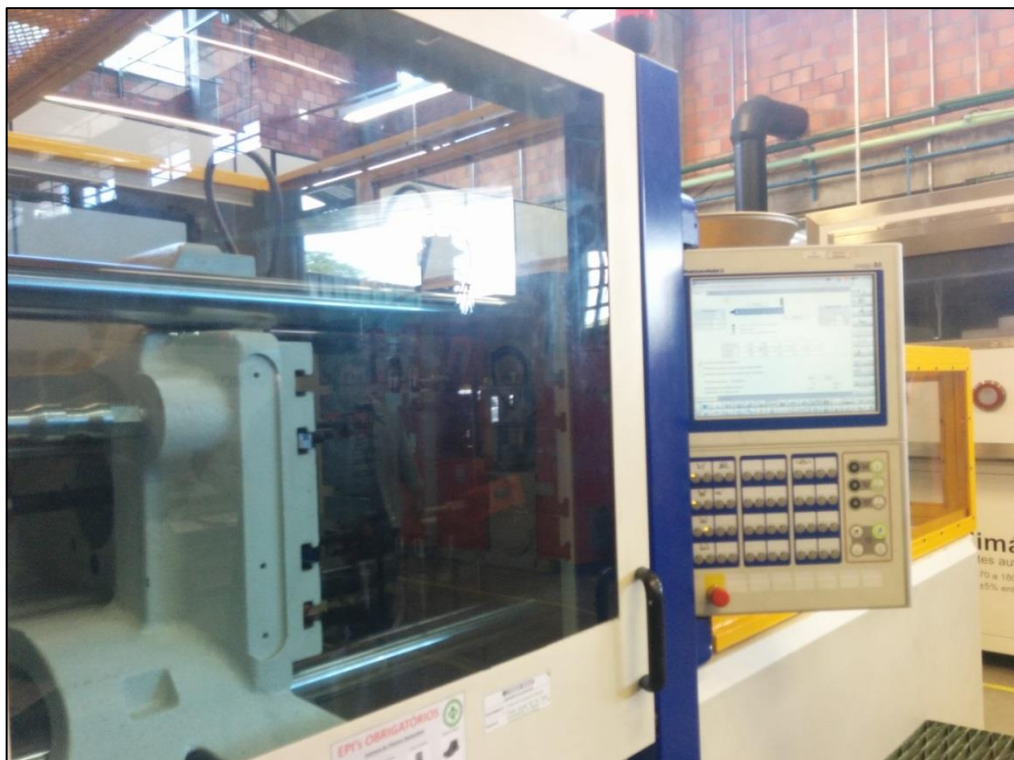
Figura 17: Injetora do CETEPO, visão da lateral da rosca recíproca, modelo TM 110/210 da marca Battenfeld.
