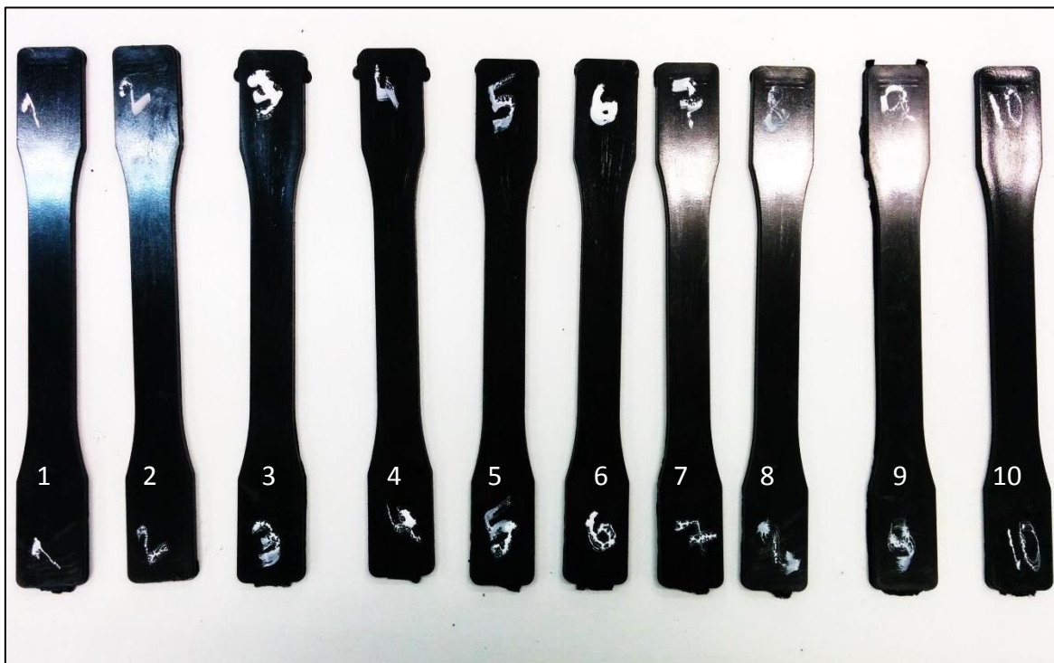
Figura 19: corpos de prova para tração obtidos por injeção no CETEPO
