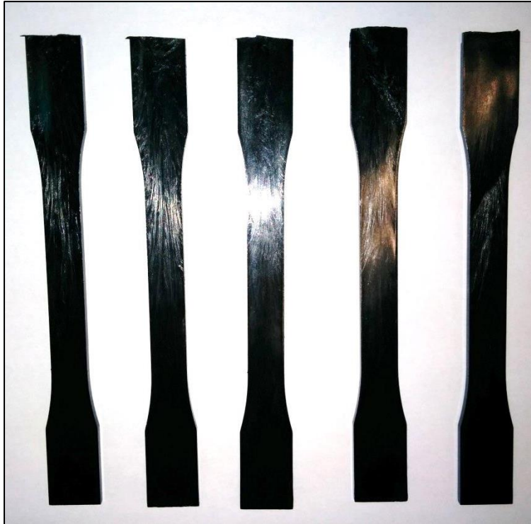
Figura 16: Corpos de Prova para tração obtidos na injetora do LPA
