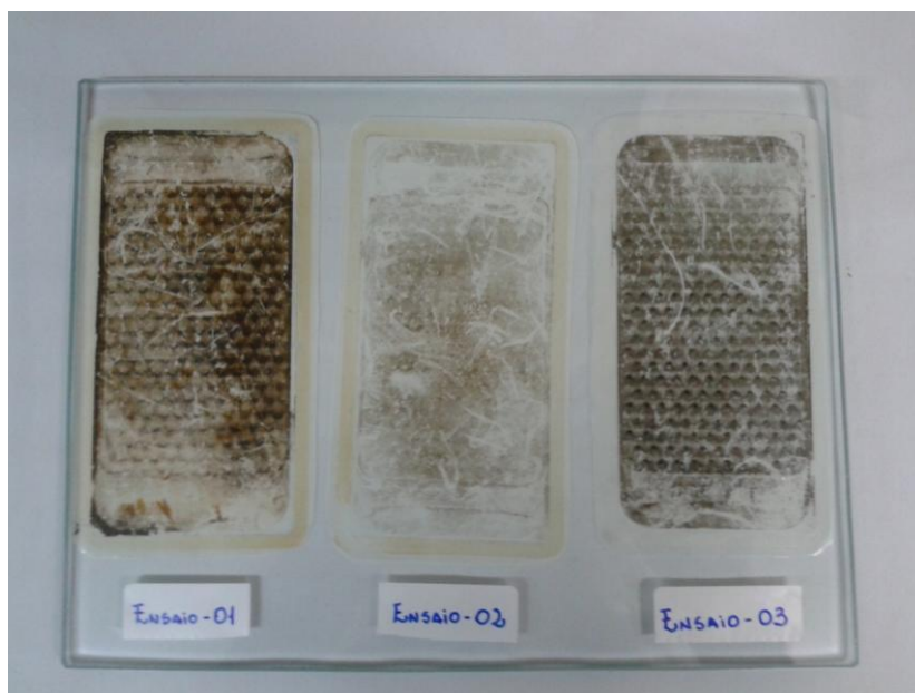
Figura 5.5: Fotografia das membranas de UF após o uso, para os três experimentos realizados.
