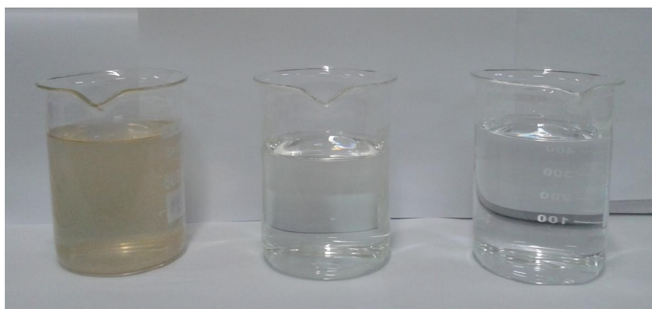
Figura 5.11: Comparação visual do efluente hospitalar após tratamento biológico (esquerda), tratado por UF (centro) e água potável (direita).
