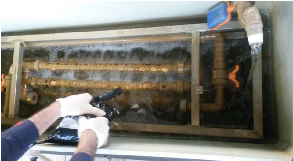
Figura 5.1: Fotografia do módulo de membranas antes da limpeza com ácido oxálico (1 ppm), condições de operação: pressão -0,1 bar, temperatura 25°C e vazão de 1,7 \times 10^5 \text{ m}^3 \text{ s}^{-1} .
