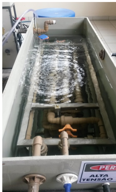
Figura 4.3: Imagem do tanque que contém os módulos de membranas de fibras ocas de UF.
