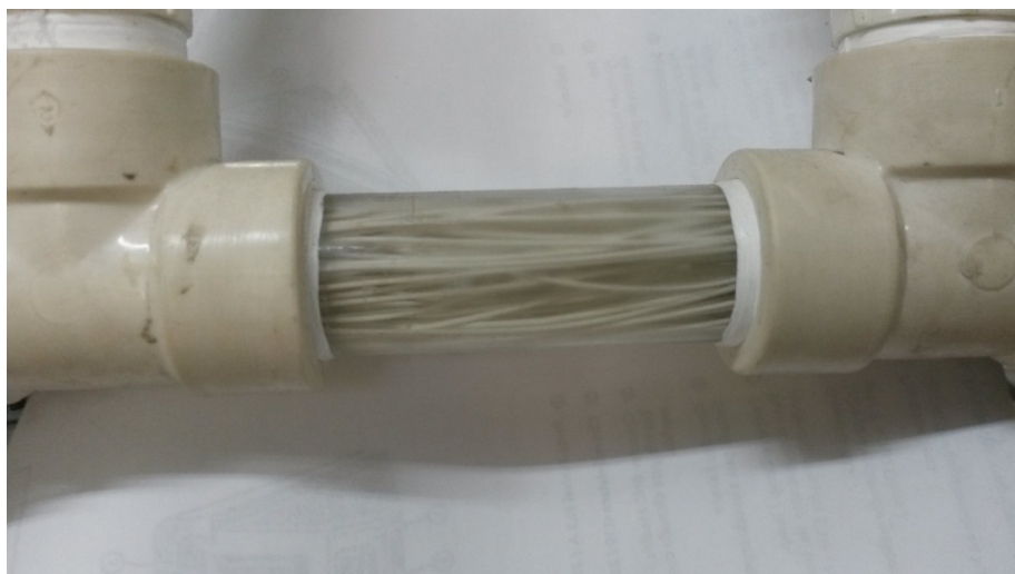
Figura 4.1: Detalhe das fibras ocas de poliétersulfona no módulo utilizado no sistema de bancada.
