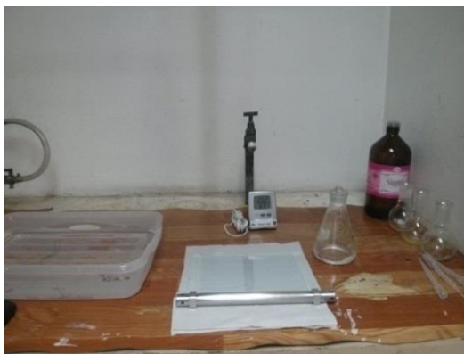
Figura 3.1: Equipamentos utilizados na preparação de membranas pela técnica de inversão de fases por imersão precipitação.
