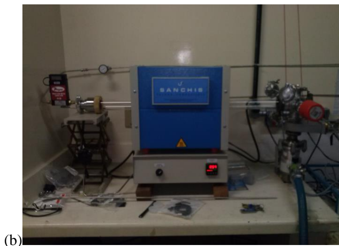
Figura 4.6 - (a) Esboço do reator CVD com as três partes essenciais do sistema. (b) Foto do reator montado na sala do subsolo do prédio 43.173 do Campus do Vale na UFRGS.
