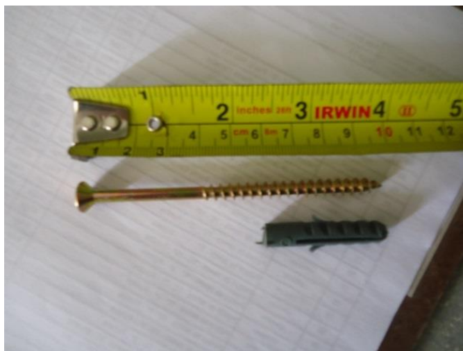
Figura 35 – Parafuso utilizado para fixação das esquadrias
