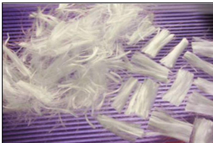
Figura 3.5: Aspecto das fibras de polipropileno com 24 mm de comprimento (fonte: www.fridulsa.com.uy ).
