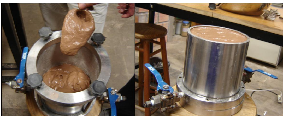
Figura 3.14: Moldagem da amostra no permeâmetro.
