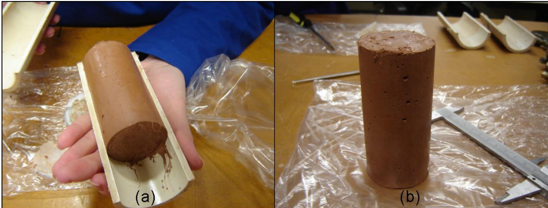
Figura 3.10: (a) Desmoldagem; (b) Medição do corpo de prova.
