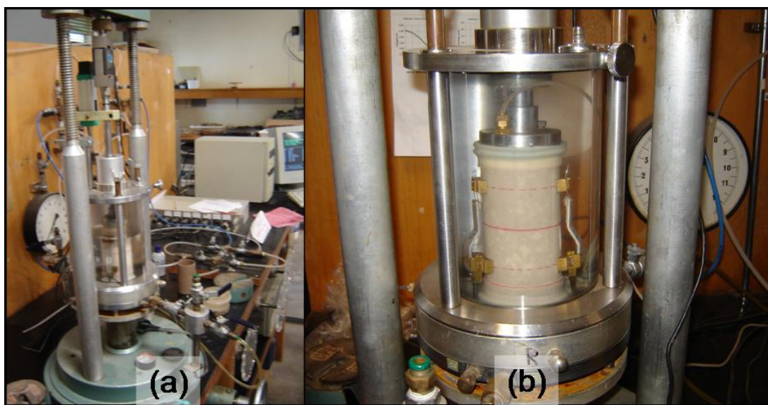
Figura 3.12: (a) Instalação do ensaio triaxial; (b) Detalhe da amostra.
