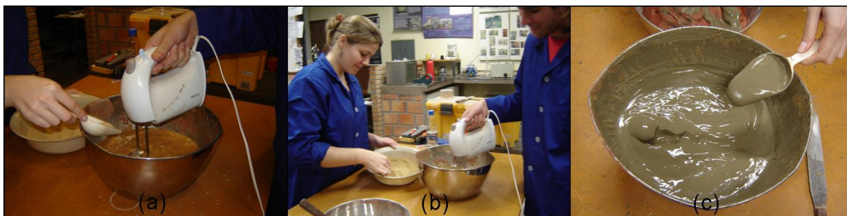
Figura 3.8: Terceira etapa (a) Adição de bentonita; (b) Mistura mecânica; (c) Mistura com cimento.
