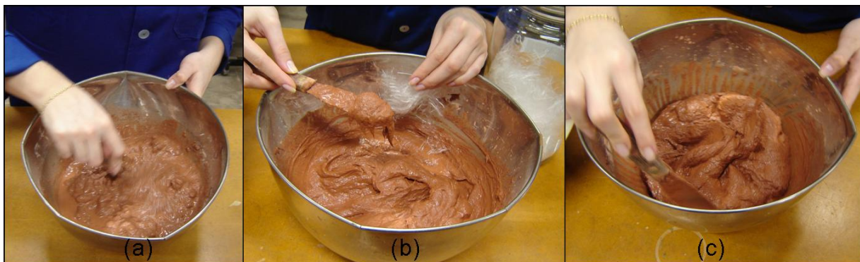
Figura 3.7: Segunda etapa (a) Solo úmido; (b) Solo úmido mais fibras; (c) Mistura manual.
