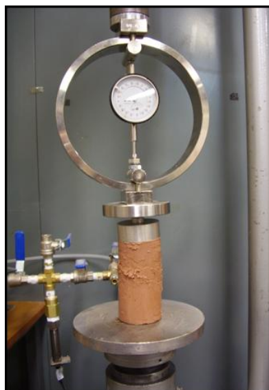
Figura 3.11: Ensaio de compressão não-confinada.
