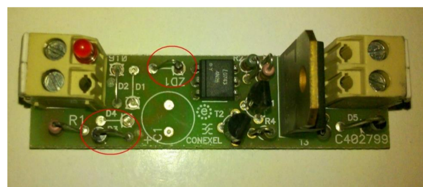
Acoplador óptico com o detalhe dos diodos curto-circuitados
