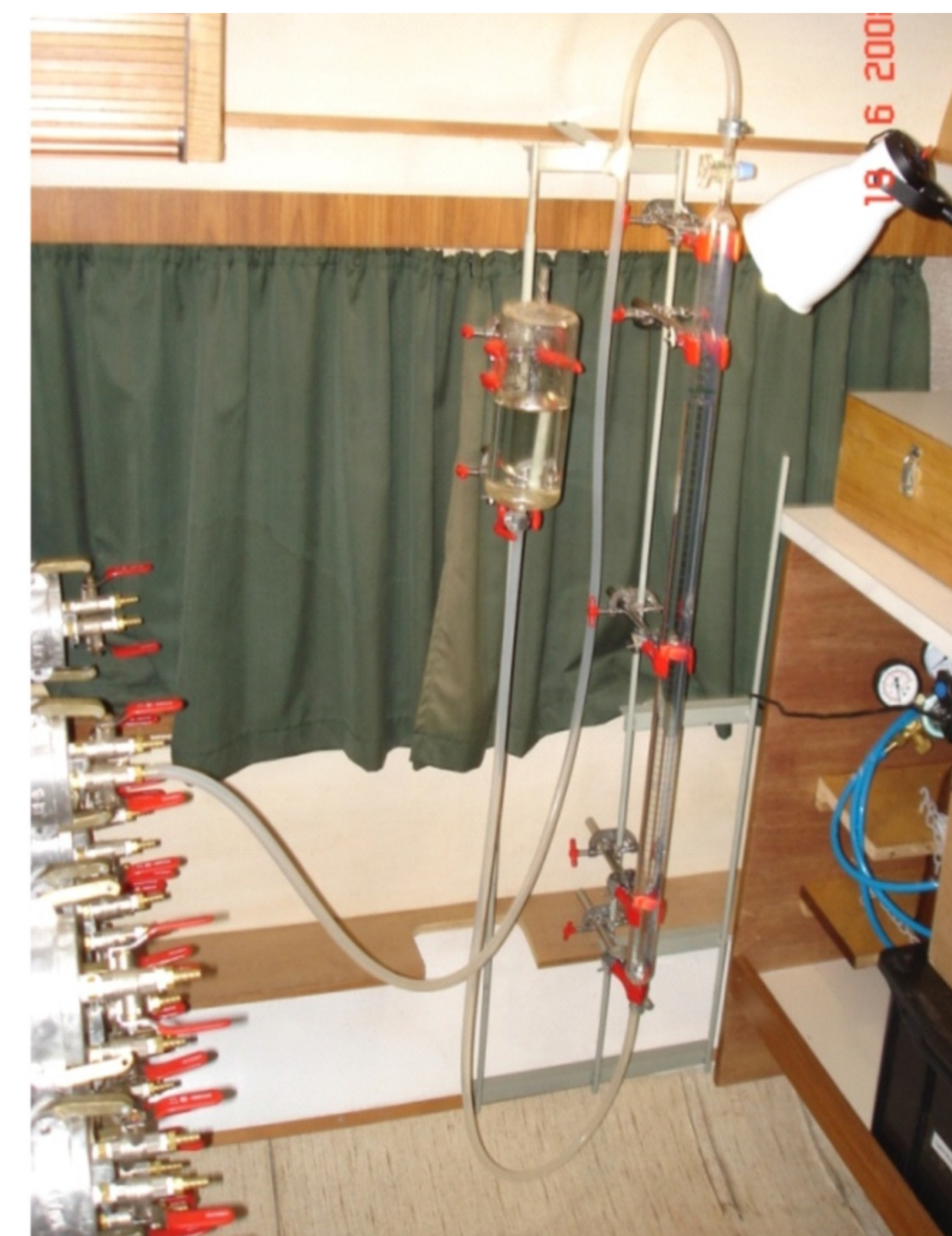
Figura 6. Coluna de vidro graduada (mm 3 ) e reservatório de água em vidro borossilicatado utilizado para a medição do volume de gás metano em desorção dos cilindros.
