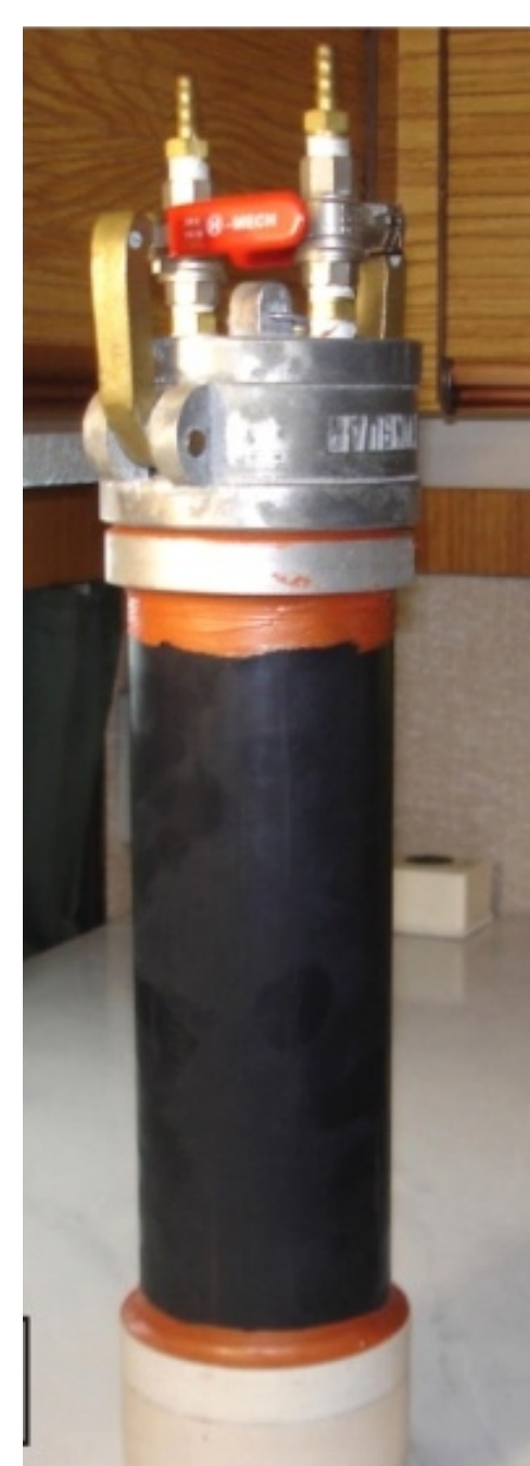
Figura 4. Cilindro de PVC com 36 cm de comprimento e 7 cm de diâmetro, utilizados para a medida do gás metano em desorção nas amostras de carvão.
