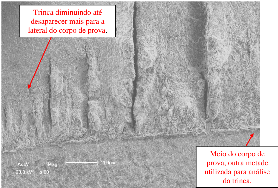
Figura 4.44: Superfície da fratura (60X) do CP ensaiado no meio etanol PRCI SFGE 2.
