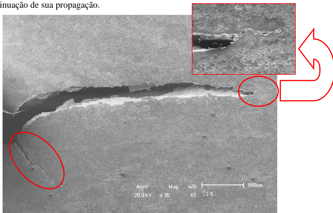
Figura 4.54: Trinca visualizada no MEV (30X). Em destaque a ponta da trinca visualizada no MEV com aumento de 240X. Observa-se o cegamento da trinca e depois o início da continuação de sua propagação.
