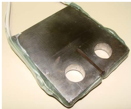
Figura 3.4: Aspecto final do CP com fios resinados.
