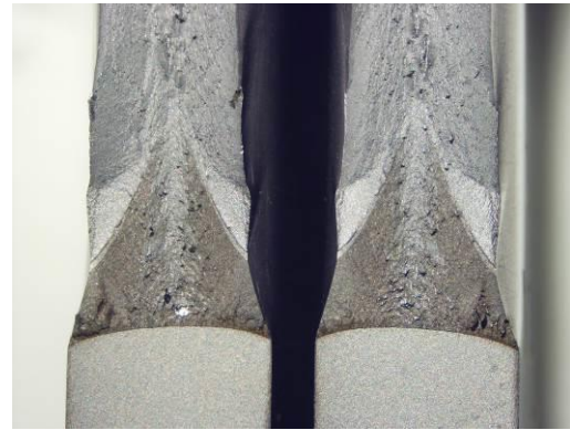
Figura 4.9: Superfície de fratura – SFGE
