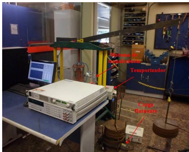
Figura 3.6: Ensaio no dispositivo Step Loading .
