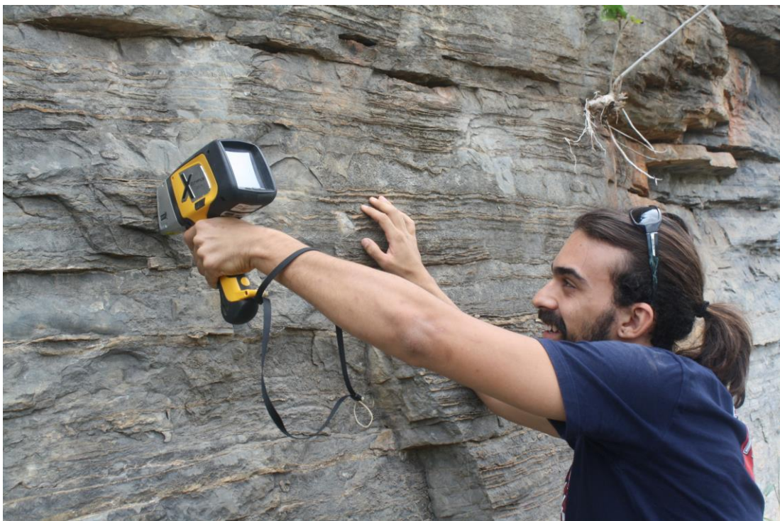
Figura 4.5: Levantamento dos perfis quimioestratigráficos com o equipamento de FRX portátil.
