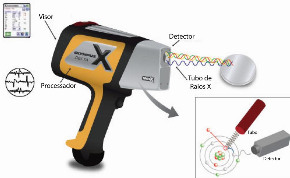
Figura 4.4: Ilustração do analisador portátil de fluorescência por Raios-X (pFRX) modelo Olympus Innov-X Delta com a representação dos principais componentes. Fonte: http://www.olympus-ims.com/pt/innovx-xrf-xrd/
