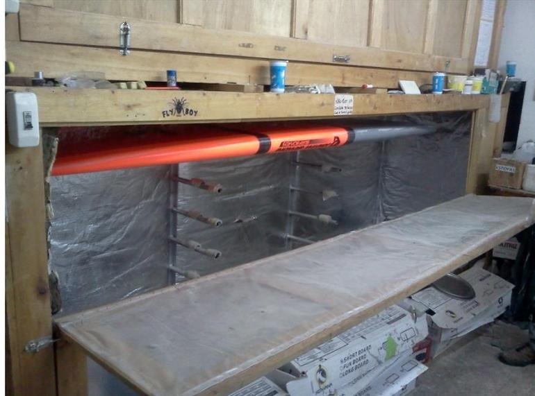
Figura 15. Forno para secagem de pranchas na Jonatan Granidni.
