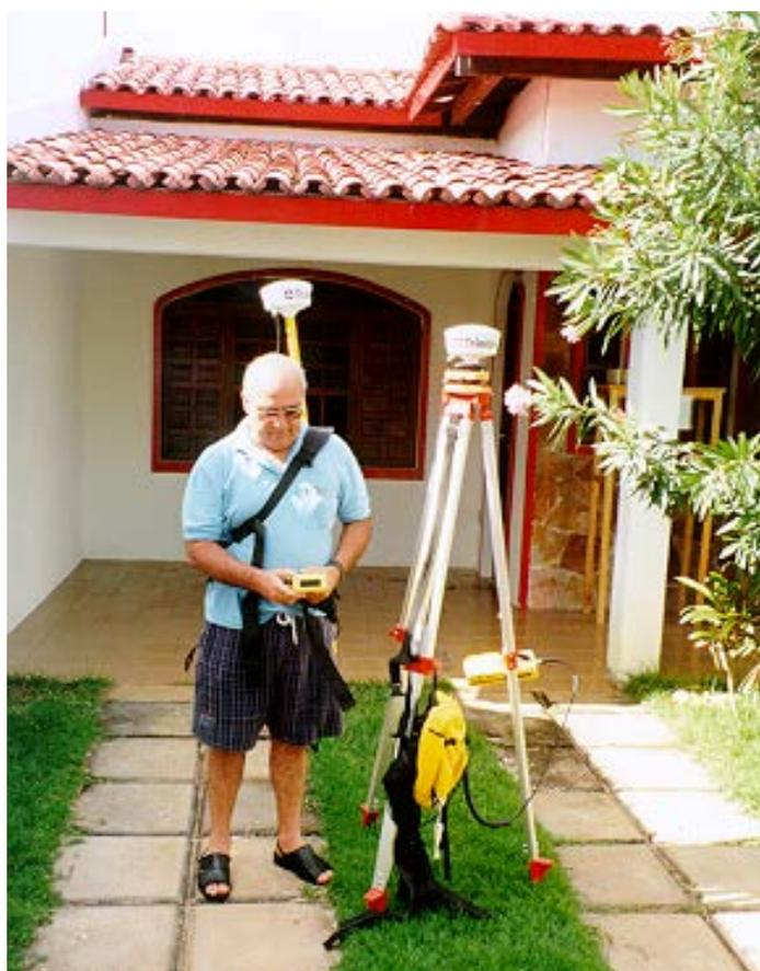
Figura 3.8- Uso do GPS na localização de uma estação de monitoramento
