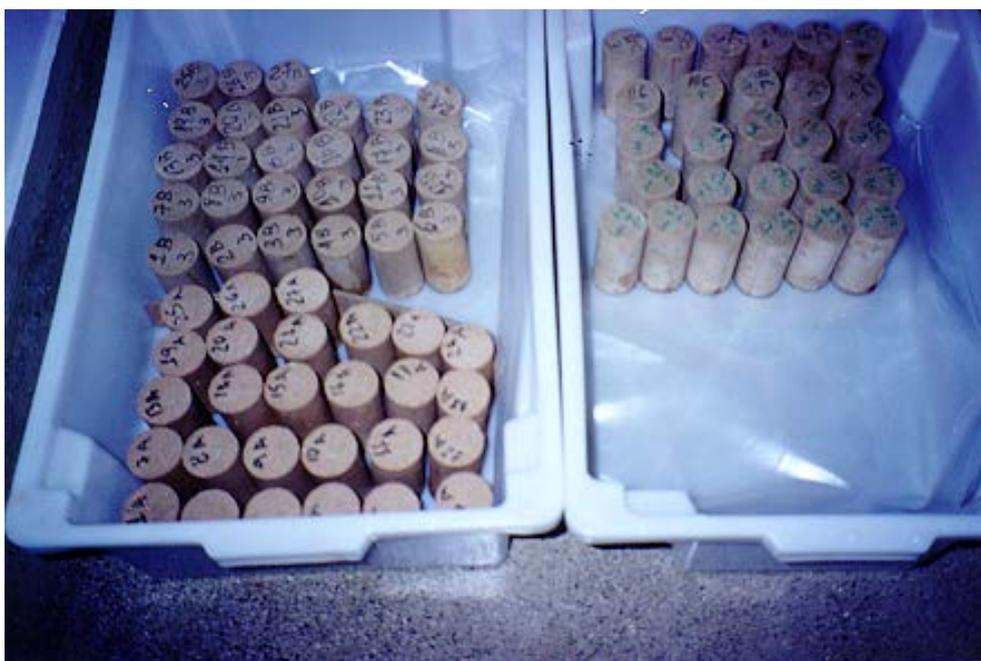
Figura 3.2 - Armazenamento dos corpos-de-prova
