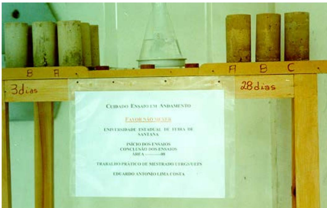
Figura 3.7 – Disposição dos corpos-de-prova de diferentes traços de argamassa nas estações de monitoramento
