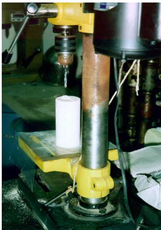
Figura 5.11 – Extração do pó nos corpos-de-prova
