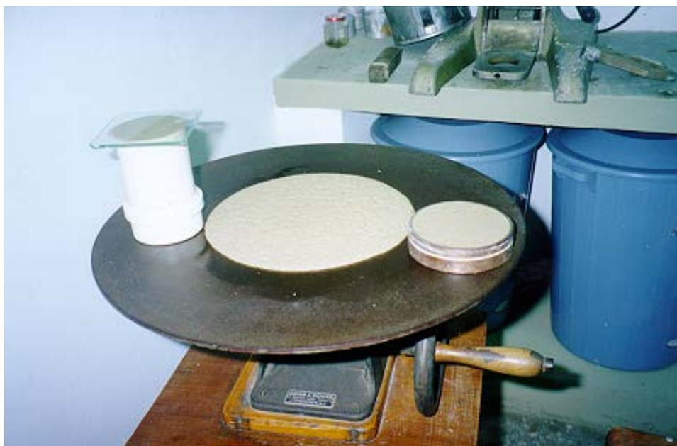
Figura 4.1 - Detalhe dos equipamentos utilizados na realização de ensaios de consistência, massa específica prática e retenção de água.
