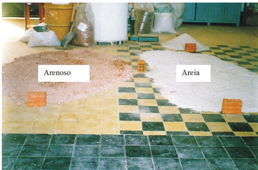
Figura 3.1 – Aspecto dos materiais utilizados na confecção das argamassas.
