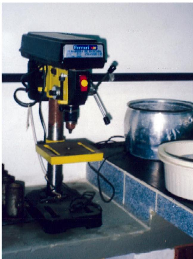
Figura 3.12- Equipamento usado para a retirada do pó do corpo-de-prova de argamassa exposto
