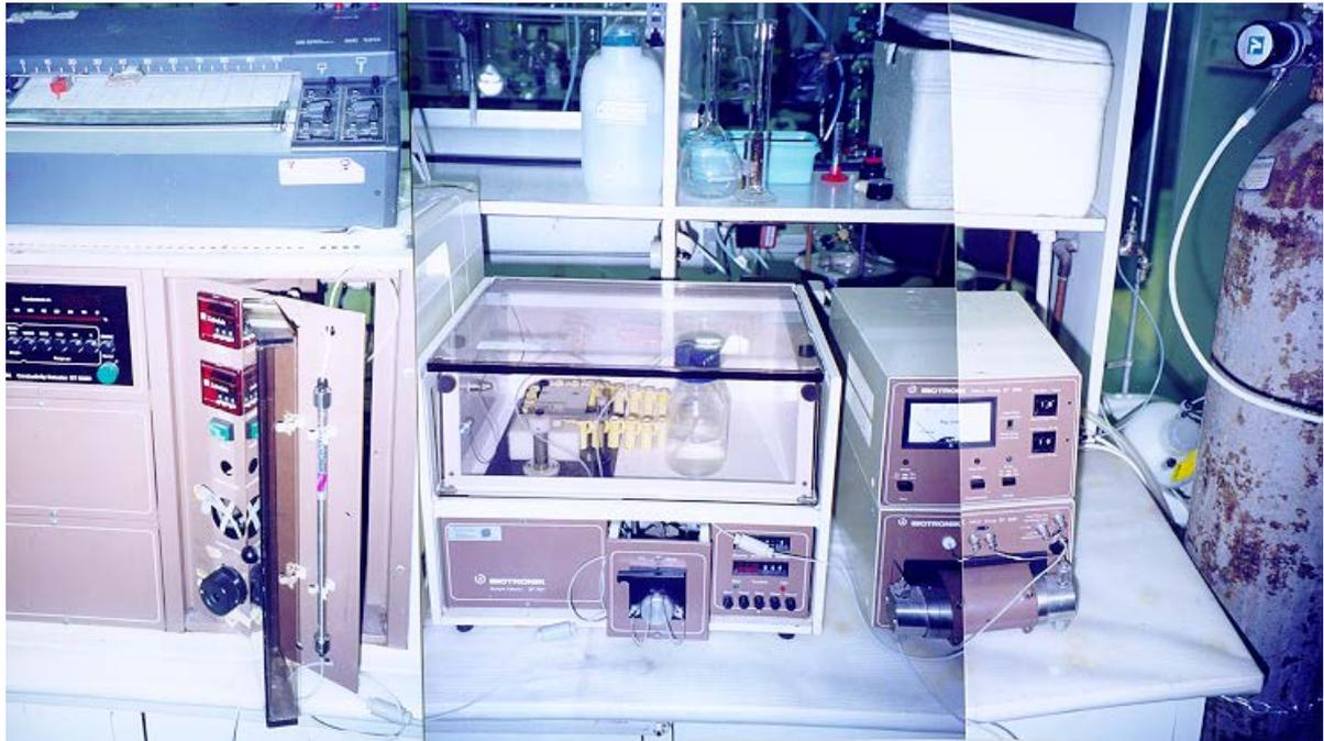
Figura 3.13 – Cromatógrafo Iônico
