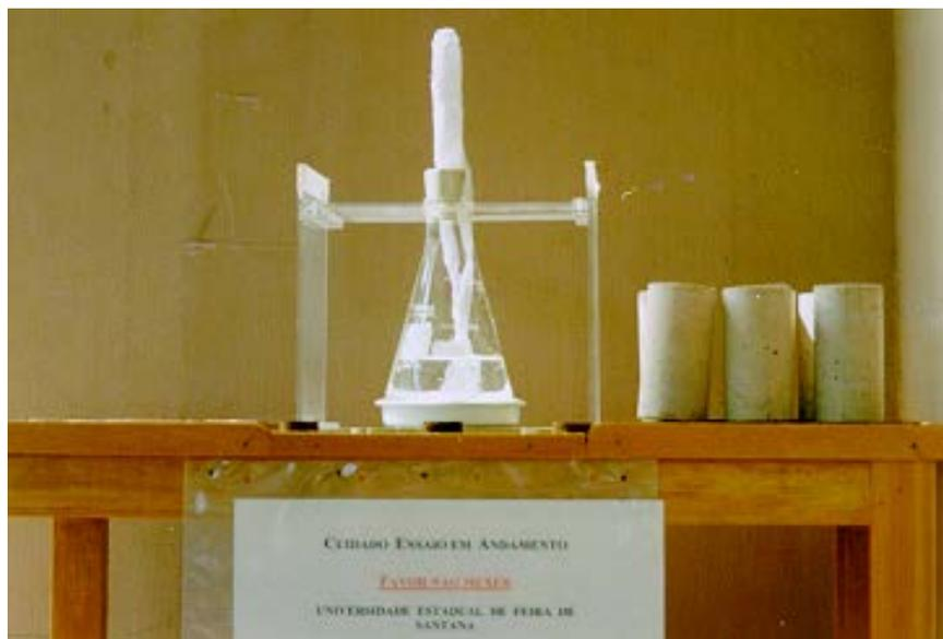
Figura 3.5 – Versão final do dispositivo da vela úmida instalado em uma das estações (agosto/2000)
