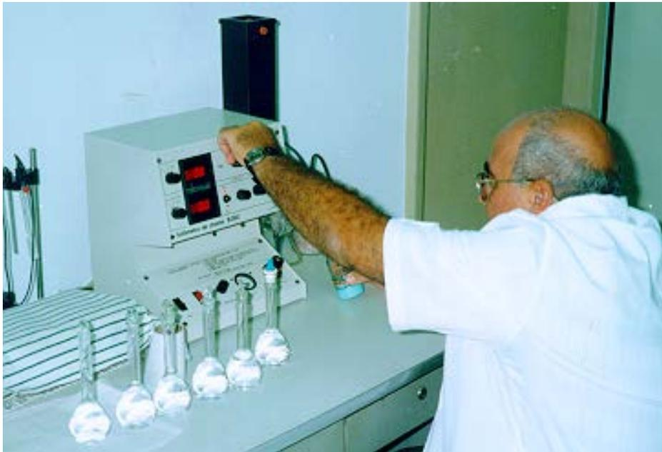
Figura 3.16 – Fotômetro de Chama em operação
