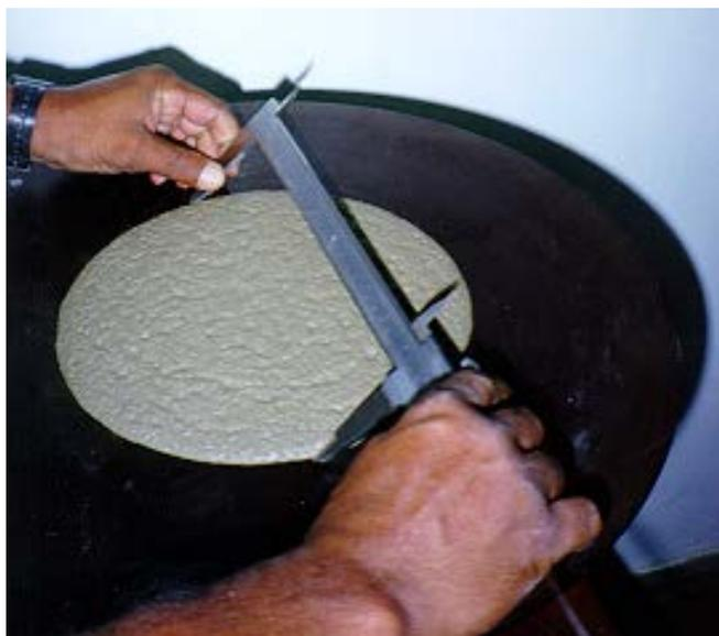
Figura 3.3 – Aspecto da medição da consistência da argamassa
