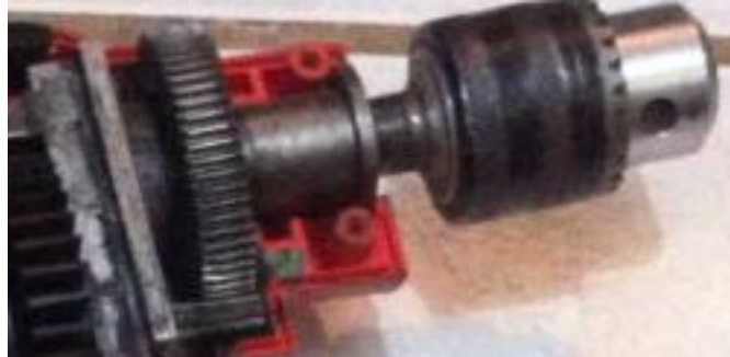
Figura 28 - Redução por engrenagem na furadeira.
