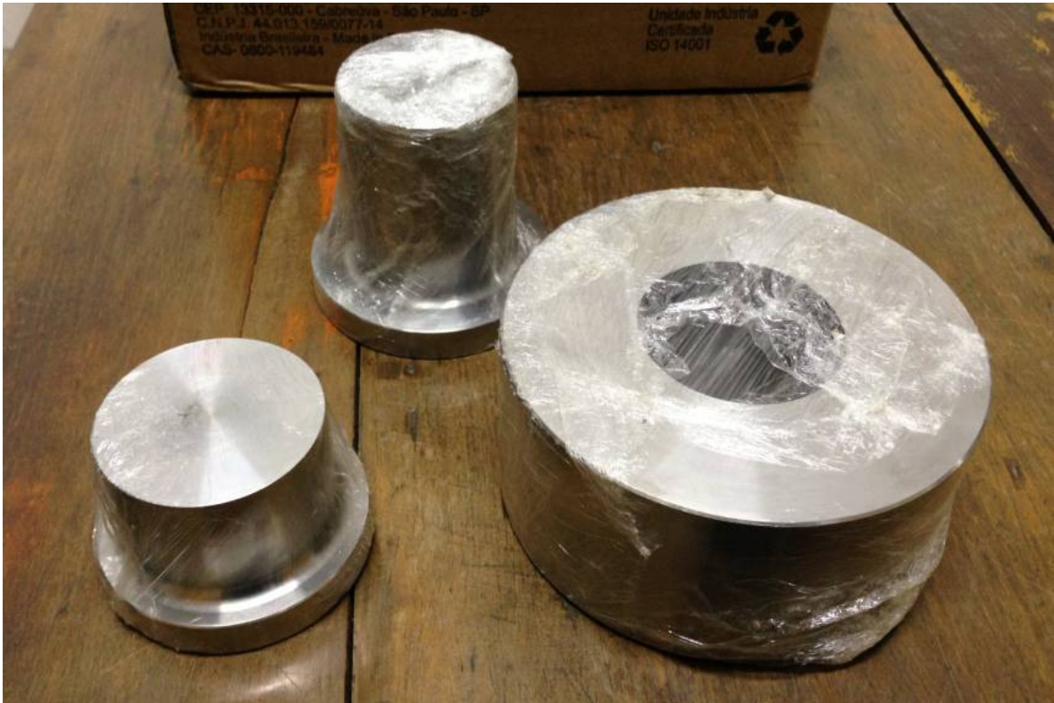
Figura 18 - Matriz para compactação do molde bruto para estator do motor universal.
