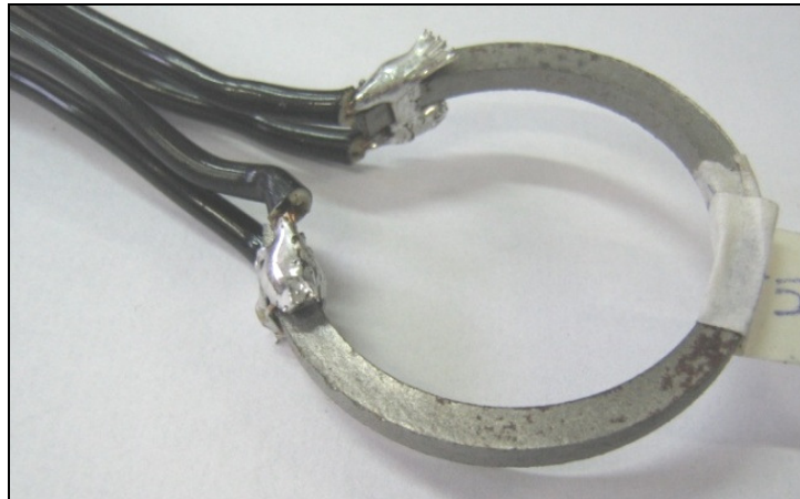
Figura B.7 - Medição de resistividade em corpo de prova em formato de anel.
