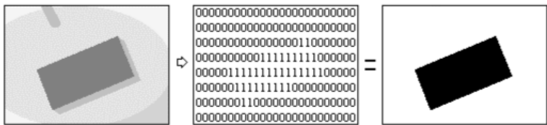
Figura 2.5 - Processo de limiarização de uma imagem em tons de cinza.
