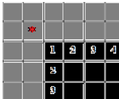
Figura 4.6 – Exemplo de pixel a ser selecionado entre 4 pixels adjacentes
