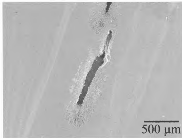
Fig. 51. Imagem de MEV mostrando o ataque por cloretos em aço AISI304L anodizado em solução ácida de molibdato a 750 mV.
