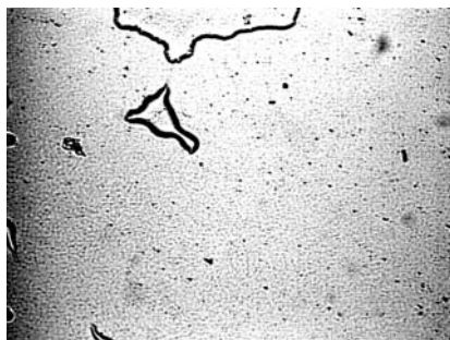
Figura 56– Micrografia de MO da mistura PVDF/PMMA 60/40 processada em misturador HSM a 145°C em (a) 2 min; (b) 5 min e (c) 6 min (aumento 200x).
