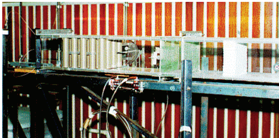
Figura 3.2: Vista da seção de testes com sensores e banco de tubos (escoamento da direita para esquerda).
