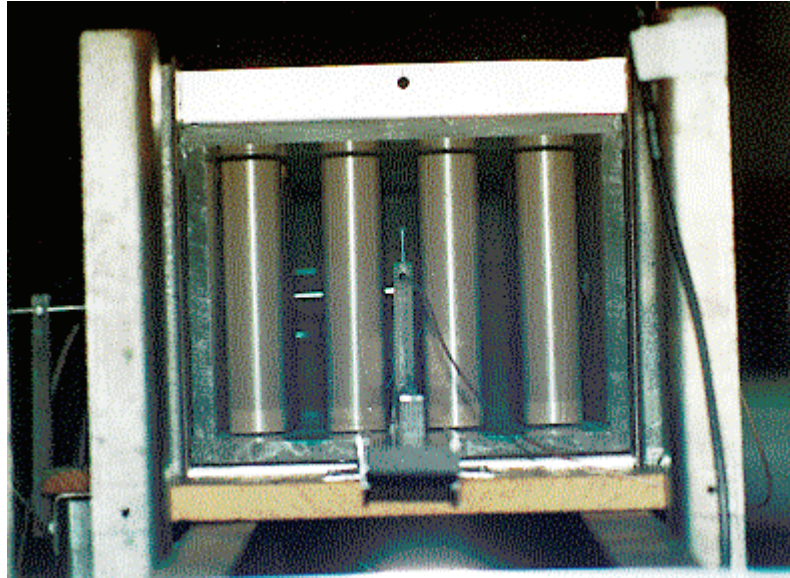
Figura 3.7: Vista da descarga do canal com banco de tubos quadrangular e do posicionador da sonda do anemômetro de fio quente e do posicionador reto da sonda de fio quente.
