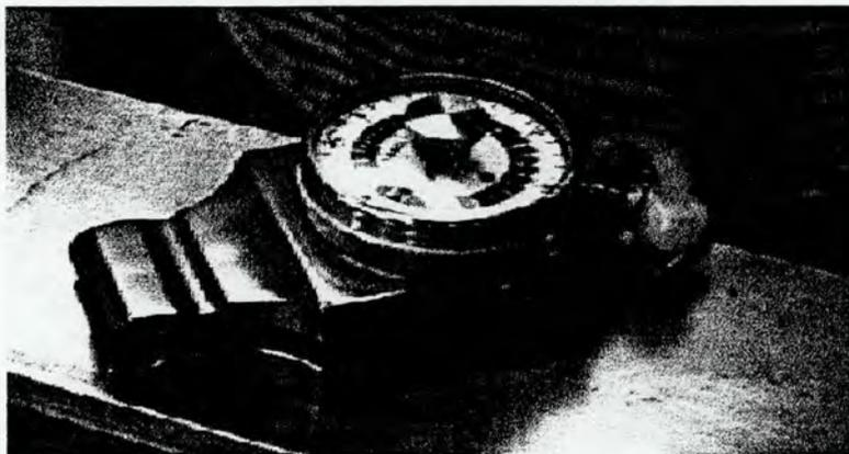
Figura 64. Célula de carga para medir força de pega em pinça.
