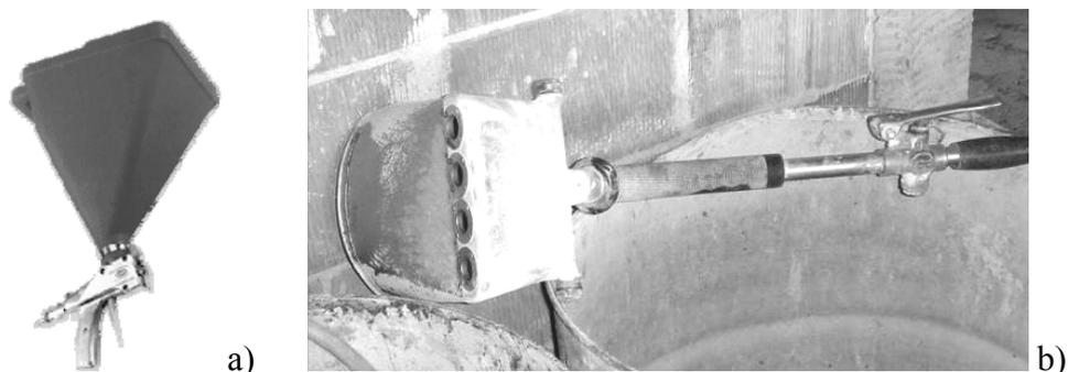
Figura 4: projetor com recipiente acoplado – pistola (a) e caneca (b)
