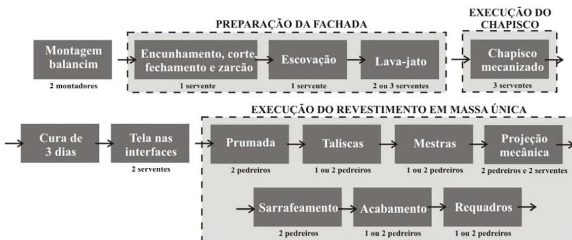
Figura 30: seqüência de preparação e produção do revestimento
