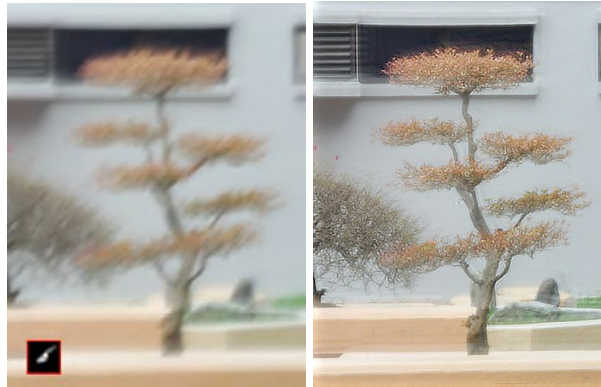
Fig. 2.1 Exemplo de deconvolução não cega. (Esquerda) Imagem de entrada com o respectivo kernel que gerou o borramento. Extraído de Shan et al [2008] (Direita) Imagem resultante do processo de deconvolução não cega proposto por Fortunato e Oliveira [2014].
