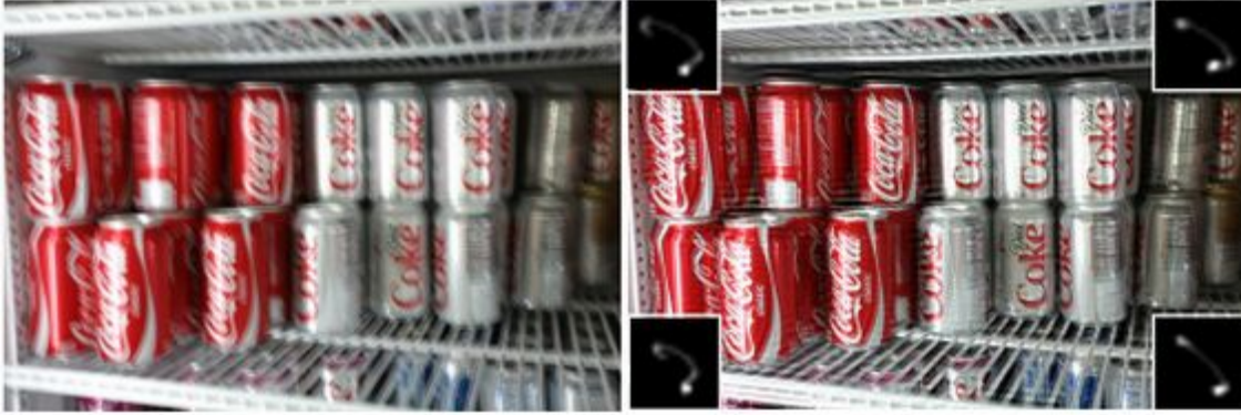
Fig. 6.7 Resultado obtido Imagem de entrada, borrada (esq.), imagem de saída, após a execução do método, que se utiliza de kernels que variam espacialmente. Por conta disso, há a possibilidade de se encontrar mais de uma PSF para uma determinada imagem. Extraído de Joshi et al. [2010].
