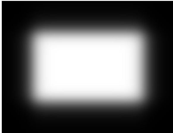
Fig 2.4 Exemplo de máscara de suavização: Exemplo de máscara de suavização que é utilizada no algoritmo de deconvolução.
