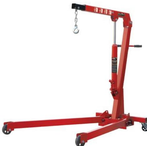
Figura 4.9: Grua para o içamento dos braços mecânicos (Motointegrator, 2015).
