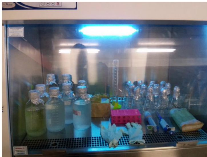
Figura 3.1: Materiais utilizados para a preparação dos experimentos, durante sua exposição à radiação UV na cabine de segurança microbiológica.
