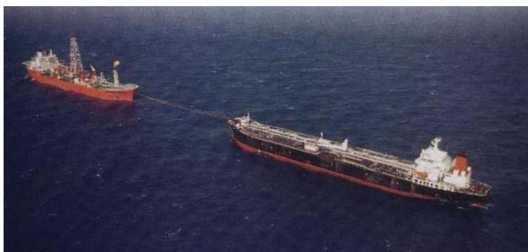
**Figura 1.** Imagem dos navios FPSO e aliviador durante operação *Offloading* [2].
