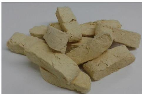
**Figura 8.** Imagem fotográfica do *masterbatch* Kevlar® 1F724 (DuPont).
