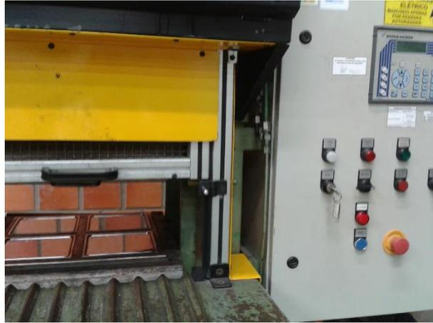
**Figura 10.** Imagem fotográfica da prensa hidráulica e molde de quatro cavidades.
