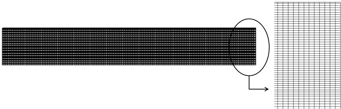
Figura 5.4 - Malha com 48×140 volumes utilizada nos cálculos [adaptado de Centeno, 2014].
