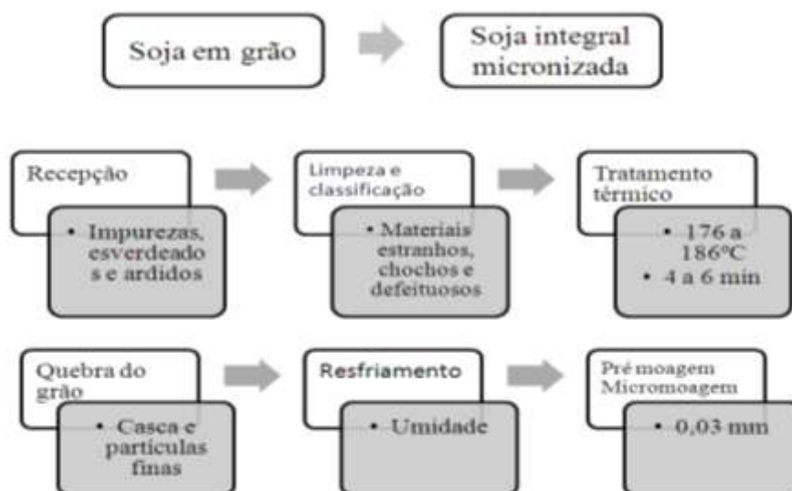
Figura 2. Fluxograma do processo industrial de produção da soja integral micronizada
