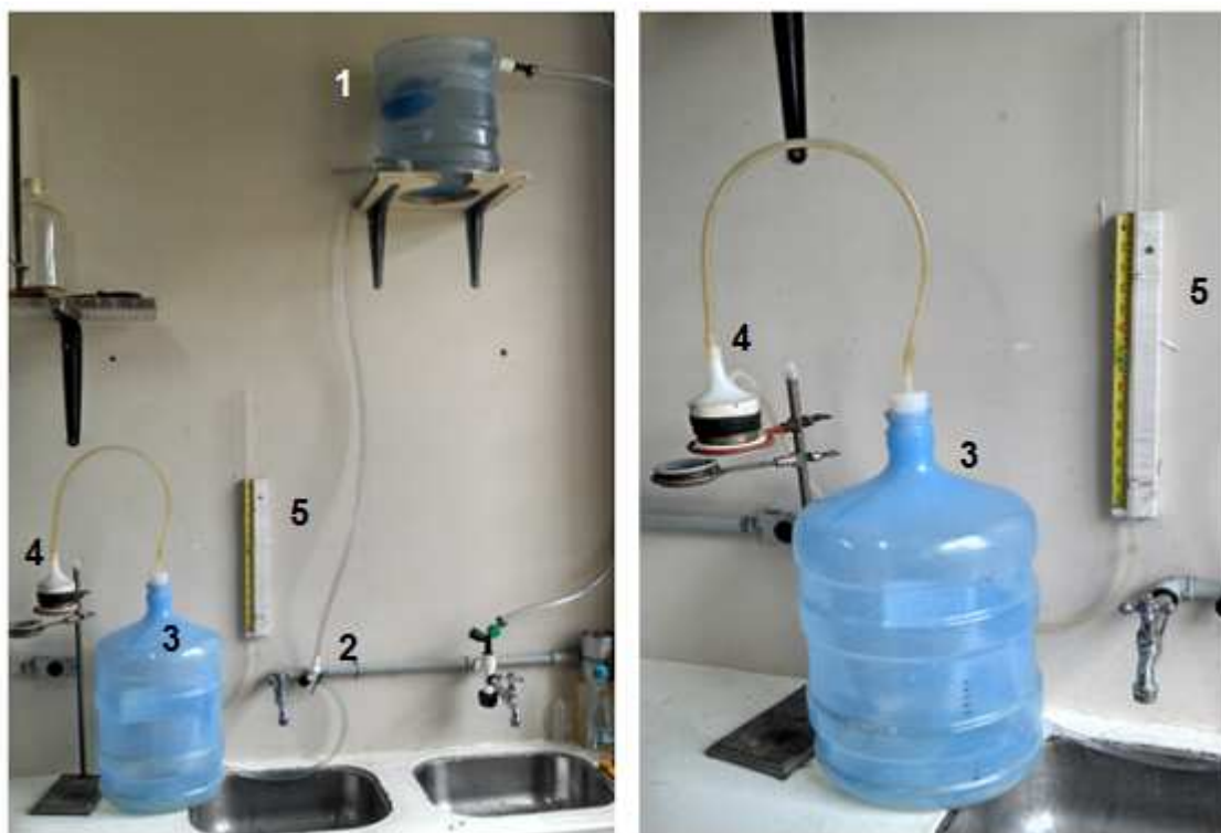
1 – Carga hidráulica constante; 2 – válvula de controle de vazão; 3 – câmara de ar; 4 – aparato para acoplamento da amostra; 5 – manômetro de água.
