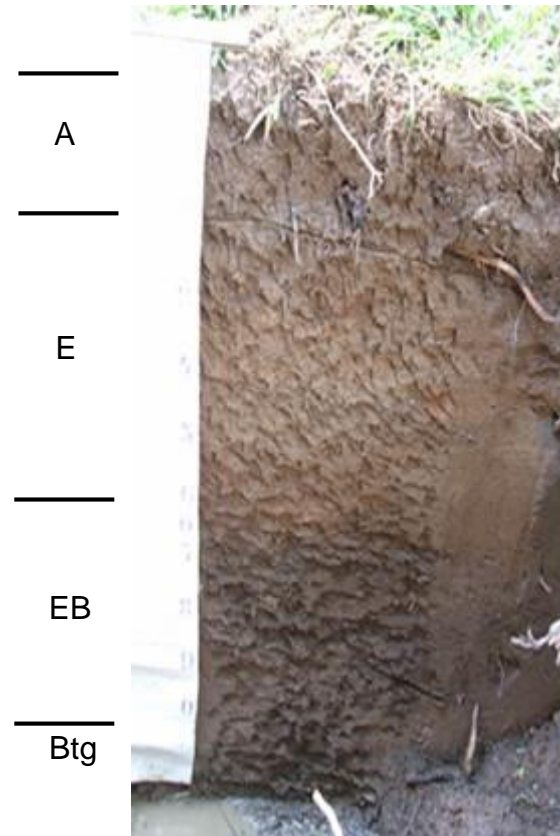
Figura 8. Perfil do Planossolo (P3), mostrando a seqüência de horizontes A, E, EB e Btg.
