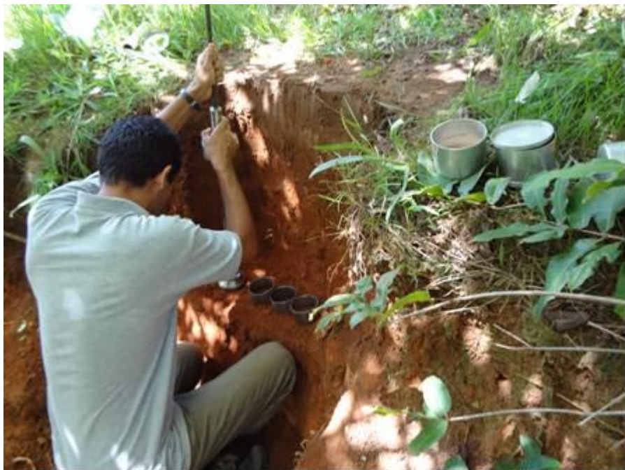
Imagem 2. Perfil 2, durante a coleta de amostras indeformadas para a determinação da densidade e porosidade do solo.
