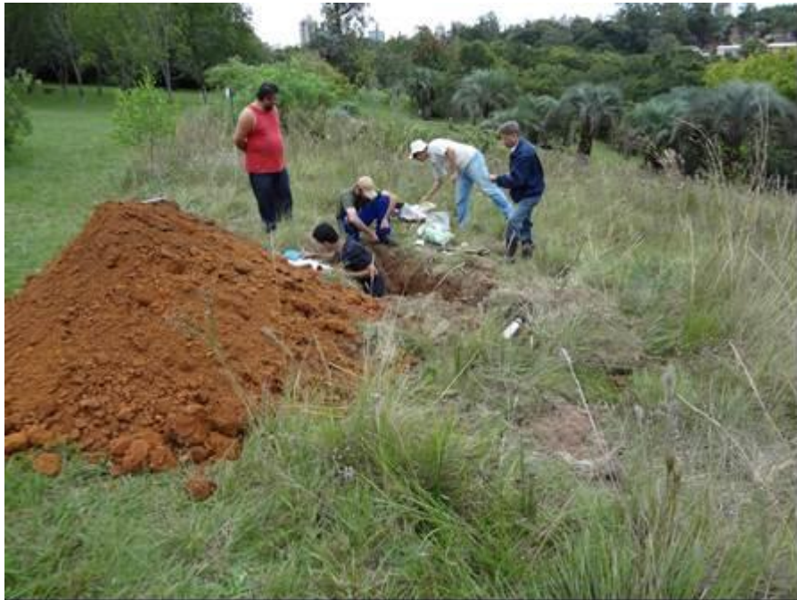
Imagem 1. Trincheira do Perfil 1, durante a descrição morfológica e coleta do solo.
