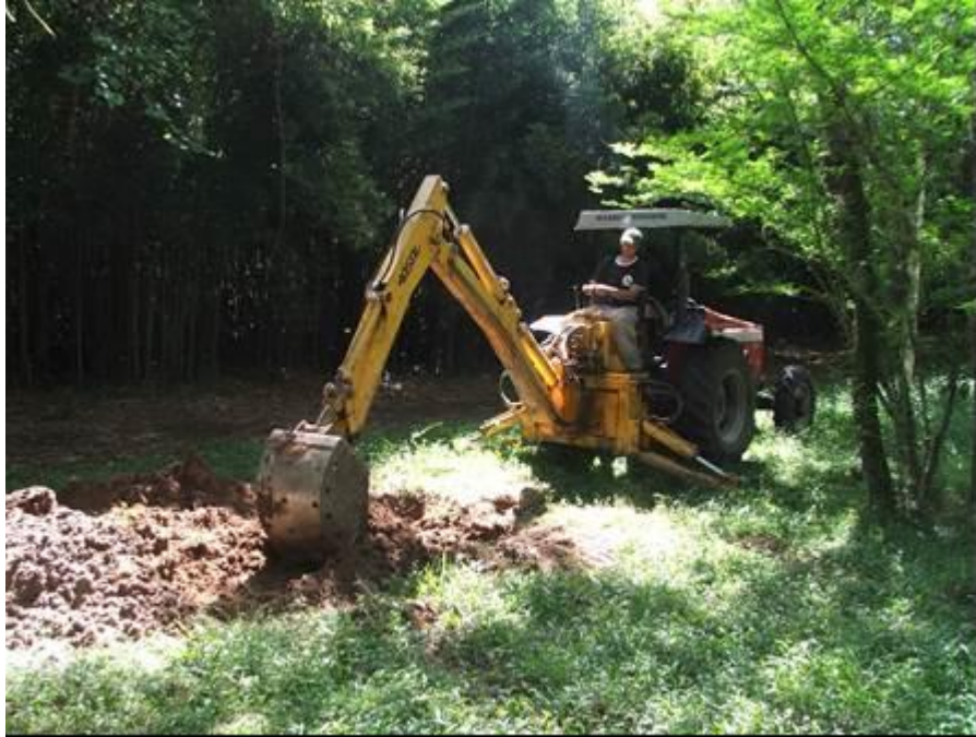
Imagem 3. Ambiente do Perfil 3, durante a abertura de trincheira para a descrição morfológica e coleta de amostras do solo.
