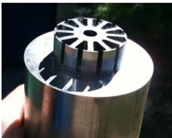
Figura 3. 23 Peça compactada sendo retirada da matriz.
