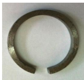
Figura 3.9 Corpo de prova para determinação da resistividade.
