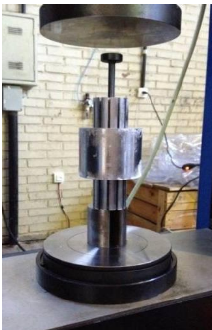
Figura 3. 22 Compactação na matriz do núcleo do rotor.
