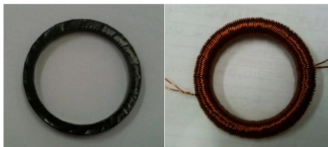
Figura 3. 11 (a) Anel isolado com fita; (b) Anel completamente bobinado.
