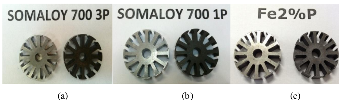
Figura 3. 24 Compactado verde (esquerda) e após tratamento térmico (direita) para os materiais utilizados
