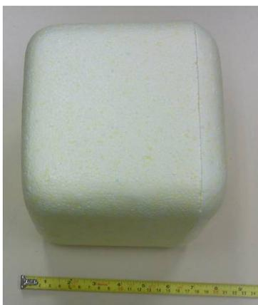
Figura 3.10 – Caixa para simulação do ambiente a ser refrigerado.
