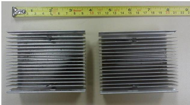
Figura 3.6 – Dissipador utilizado dentro do duto de refrigeração.
