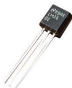
Figura 3.14 – Sensor de temperatura LM35 [37].
