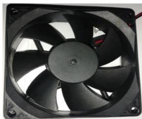
Figura 3.3 – Cooler para geração de movimento do ar no sistema.
