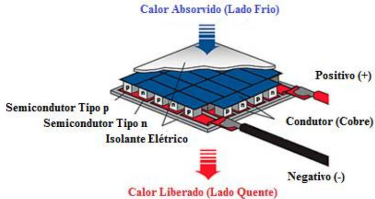
Figura 2.2 – Esquema físico de um módulo termoelétrico [8].
