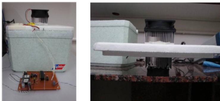
Figura 2.23 – Sistema ventoinha-dissipador-Peltier-dissipador-ventoinha instalado na tampa da caixa e detalhe do sistema na tampa da caixa.[35]
