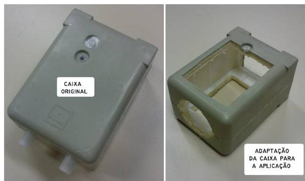
Figura 3.9 – Estrutura adaptada isolada termicamente originalmente utilizada em bebedouros .
