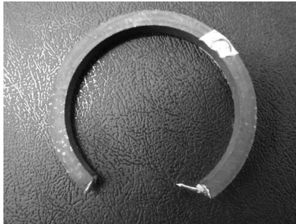
Figura 3.10 Corpo de prova de formato de anel cortado para ensaio de resistividade elétrica, nas extremidades é possível visualizar a solda de estanho.
