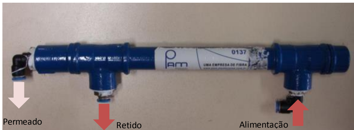
Figura 26 – Módulo 137, com membranas de microfiltração, de fibras ocas (PAM – Membranas Seletivas), usado na instalação C nos ensaios em modo de concentração.
