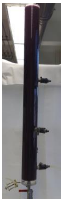
Figura 33 – Coluna usada para sedimentação: 90 cm de altura e 3,5 L de volume útil.
