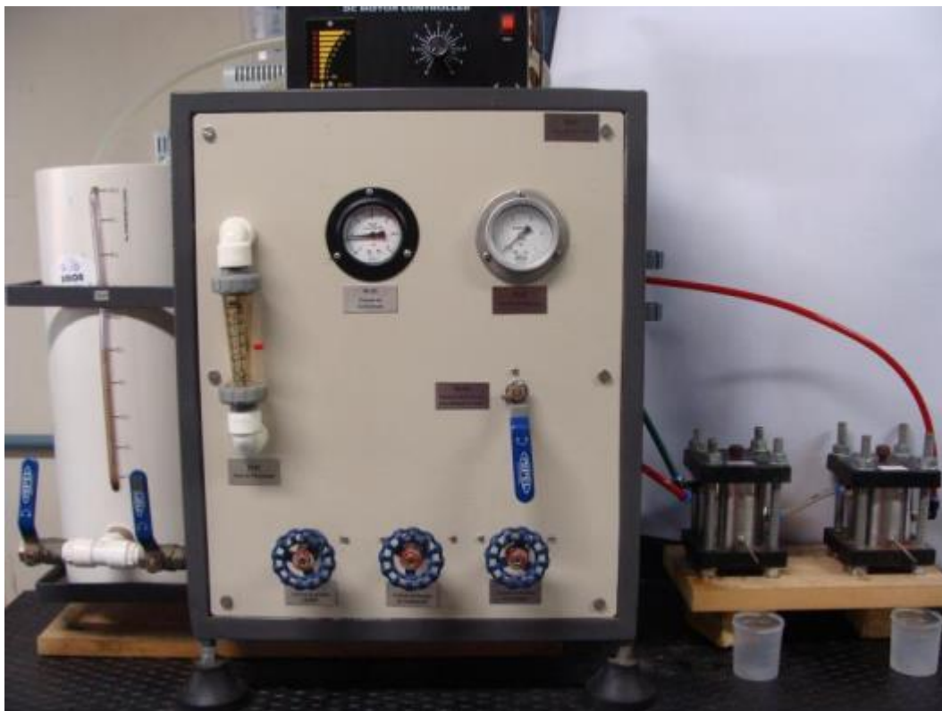
Figura 24 – Instalação C. Equipamento de microfiltração de bancada fabricado pela PAM – Membranas Seletivas (Brasil).
