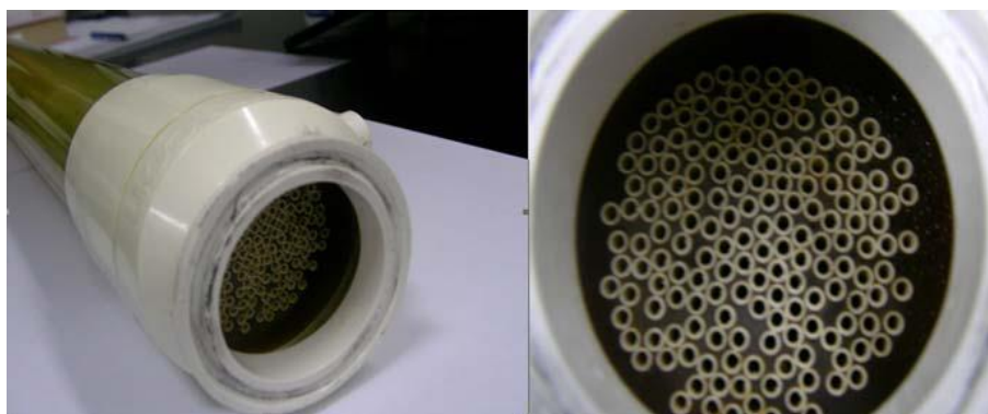
Figura 8 – Módulo de fibras ocas (RADJENOVIĆ et al. , 2008).
