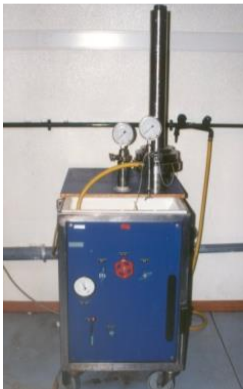
Figura 19 – Instalação A. Equipamento de filtração em escala piloto, modelo LabUnit M20 (Alfa Laval, Dinamarca).
