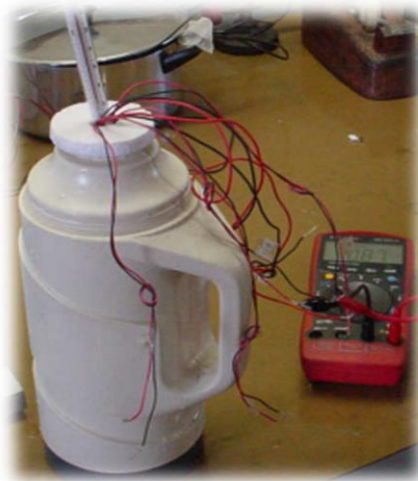
Figura 3.8: Procedimento realizado para a calibração do sensor NTC [Fonte: Autor]
