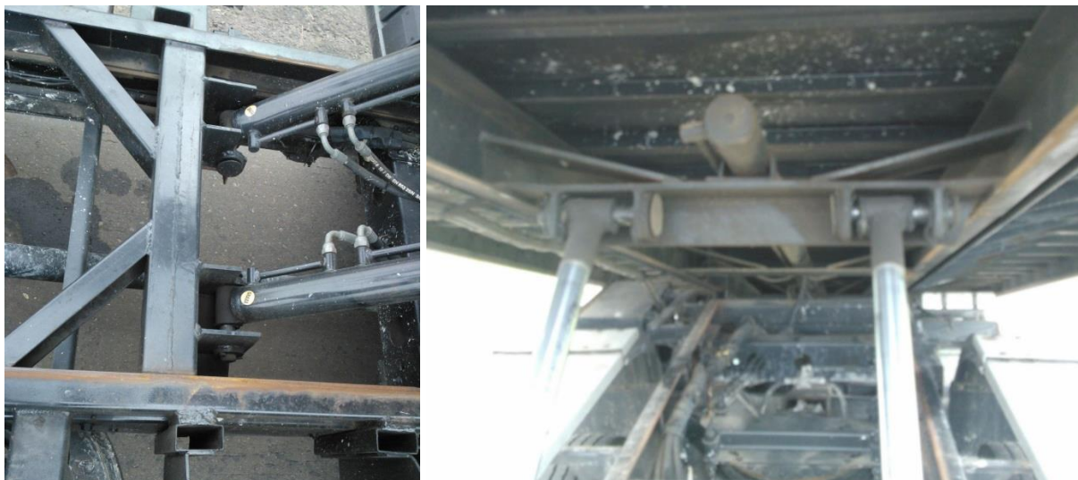
Figura II.1 – a) Fixação do cilindro hidráulico no veículo, b) Fixação do cilindro hidráulico na plataforma.
