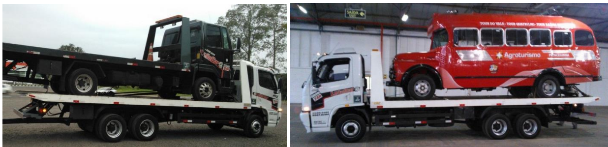
Figura III.1 – Exemplo de carregamento crítico: a) Caminhão toco de pequeno porte, b) Antigo micro-ônibus.
