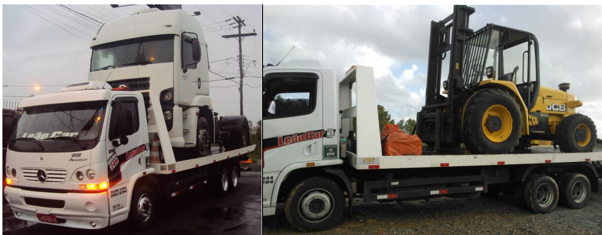
Figura III.3 – Exemplo de carregamento crítico: a) Cavalo-mecânico, b) Empilhadeira industrial.
