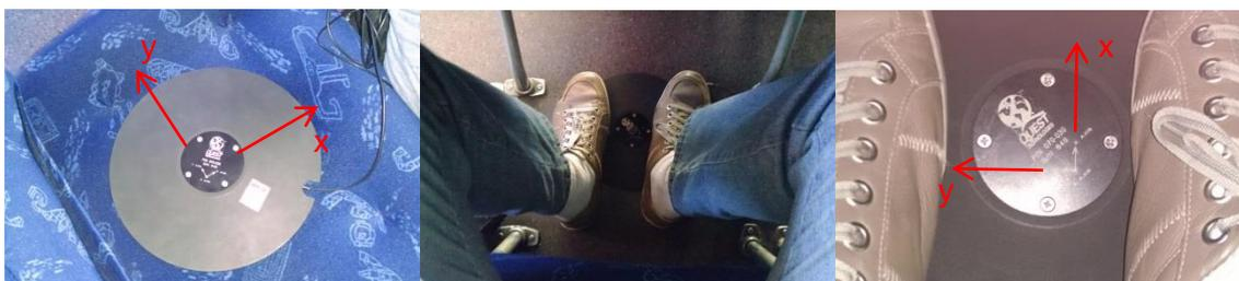
Figura 3.2 - *Seat pad* e localização das medições para assento e apoio dos pés.
