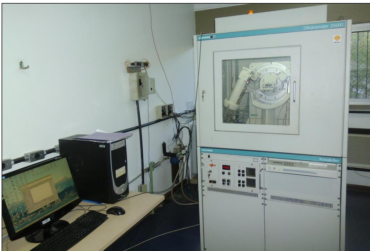
Figura 8 - Difratômetro Siemens–Bruker-AXS D5000. [Fonte: Dados da Pesquisa, 2015].
