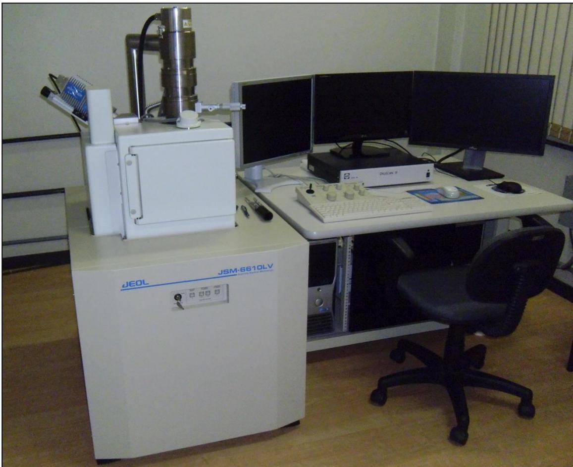
Figura 9 – Estação de MEV, modelo Jeol 6610-LV- EDS. [Fonte: Dados da Pesquisa, 2015].
