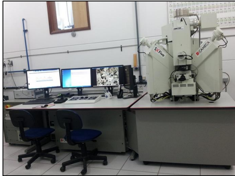
Figura 4.3: Foto da microsonda eletrônica CAMECA modelo SXFive utilizado no trabalho.
