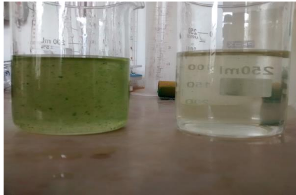
Figura 25 - Afluente e efluente do sistema de separação sólido/líquido.
