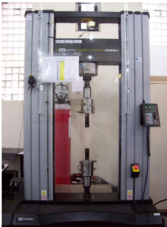
Figura 3.10 Máquina de ensaios universal da marca INSTRON utilizada para os ensaios de tração. Cortesia de Bill Paiva (LAMEF-UFRGS).
