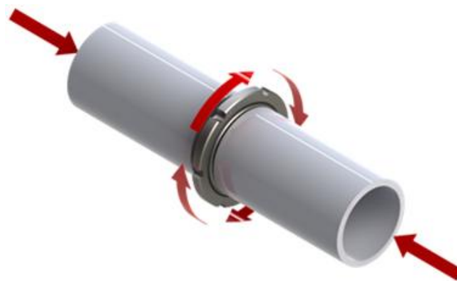
Figura 2.7 Desenho esquemático do funcionamento do processo FRIEX. Cortesia de Daniela Ramminger Pissanti.
