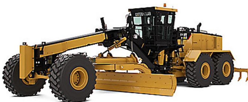
Figura 75: Motoniveladora CAT 24M.
