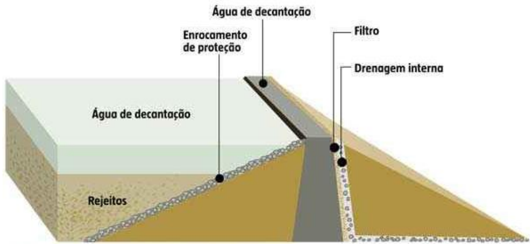
Figura 90: Método de construção de barragem a Jusante.
